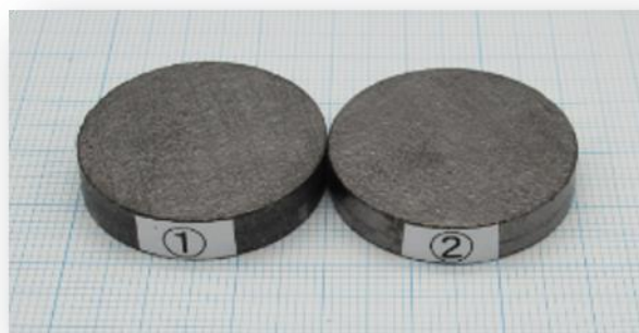
図2 試作した鉄系高温超伝導磁石
